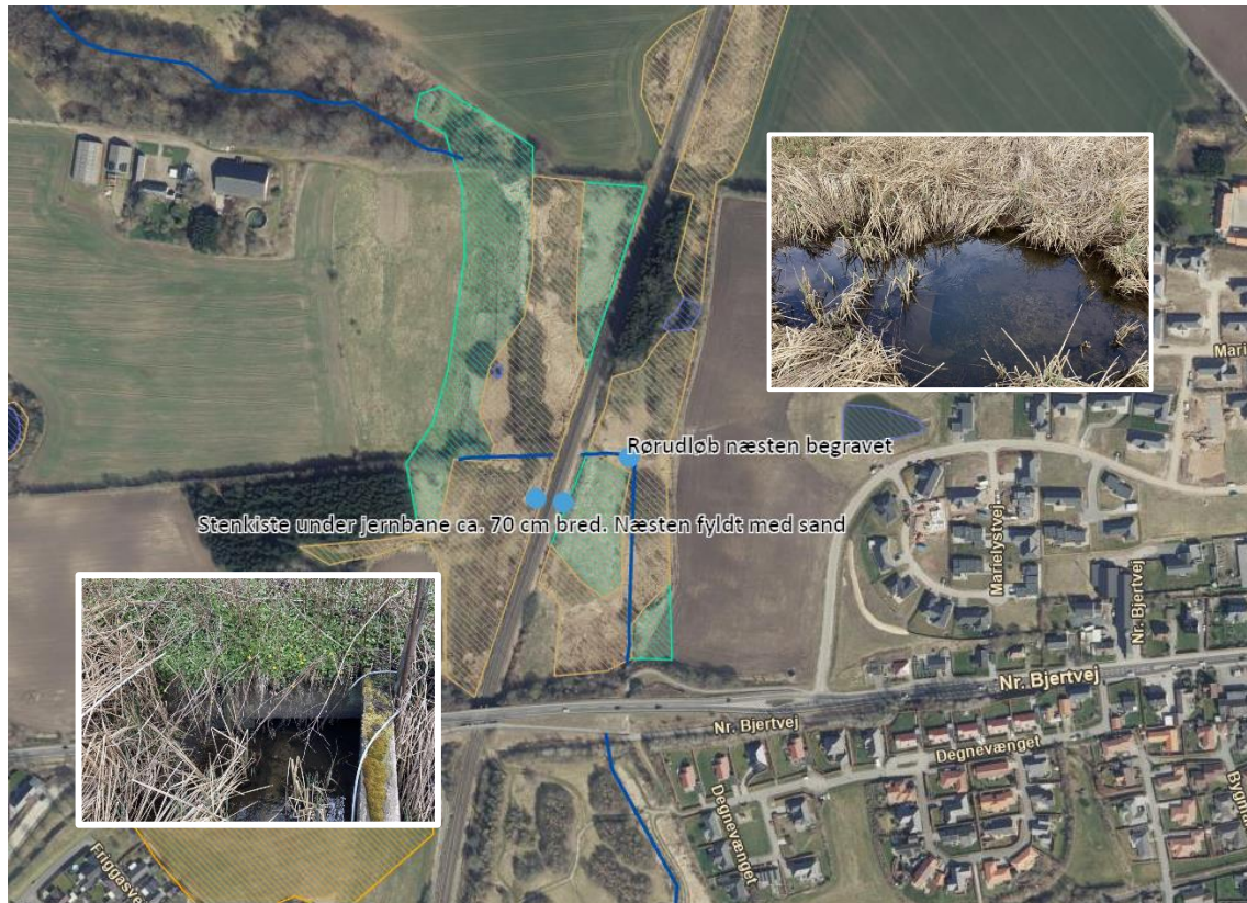
Figur 9-9 Lokalteter, hvor der må påregnes at skulle ske en oprensning som led i etablering af afvandingsløsningen. (Fotos: Kolding Kommune).
