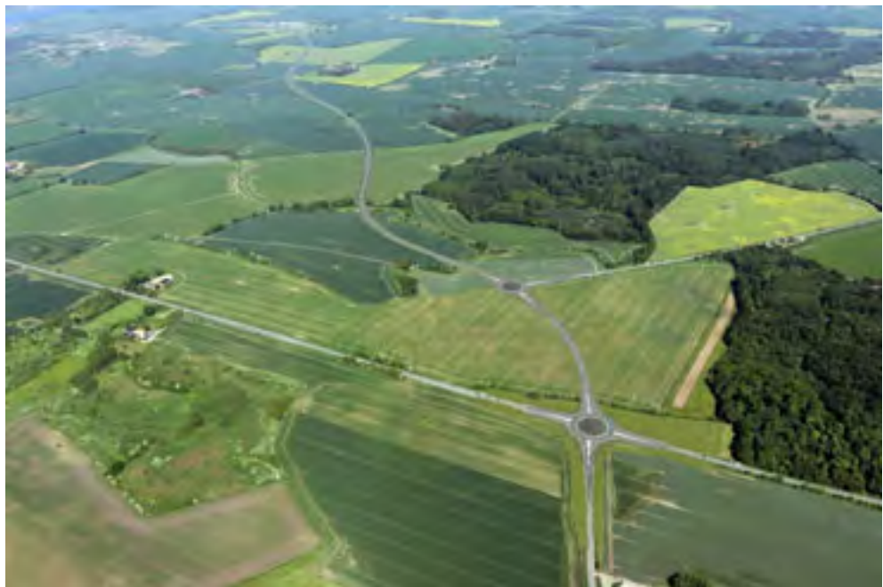
Figur 7.11 Visualisering af den nye vejforbindelse, der forløber gennem landbrugslandskabet med to rundkørsler for tilslutning til Vonsildvej og Sjølundvej.
