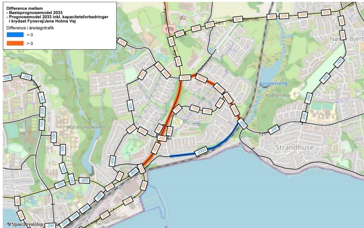
Figur 7.68, Differencekort mellem basisprognosemodel 2033 og prognosemodel 2033 med kapacitetsforbedringer i krydset Fynsvej/Jens Holms Vej.
