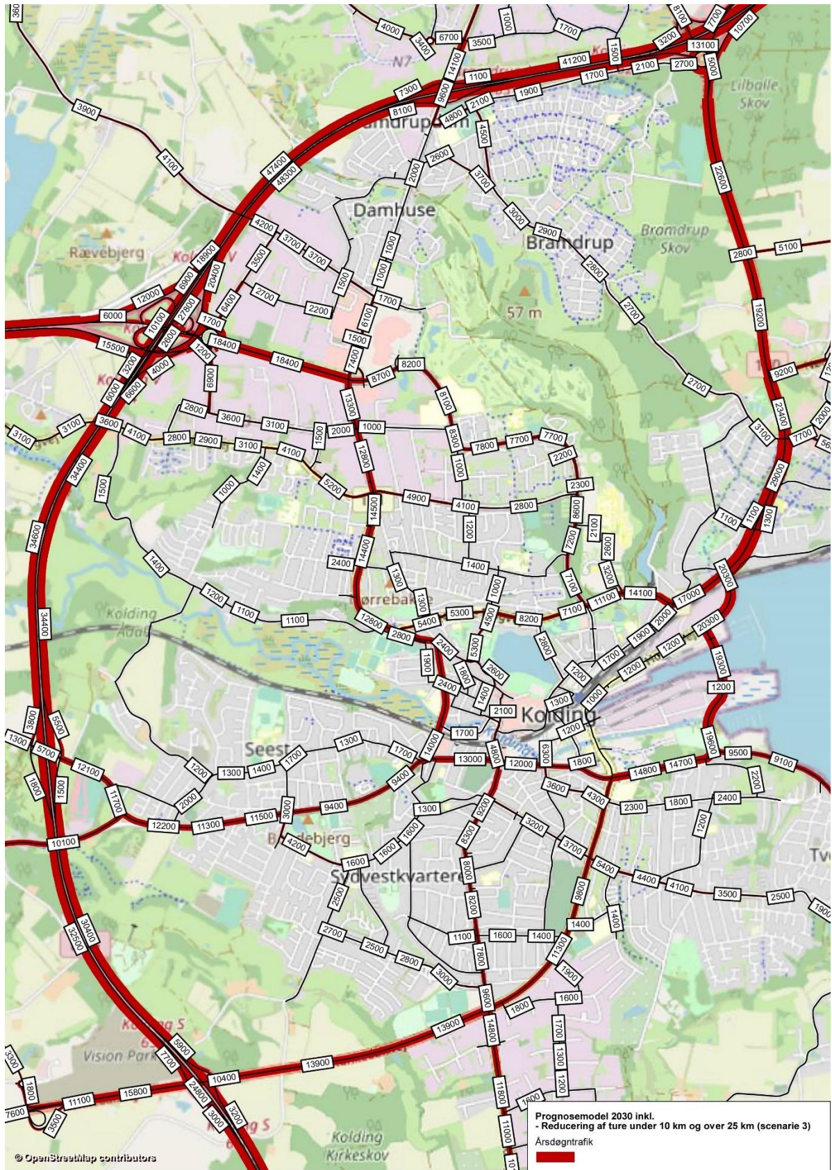
Figur 7.20, Årsdøgntrafik for prognosemodel 2030 med reducereing af ture under 10 km og over 25 km for Kolding by (scenarie 3).
