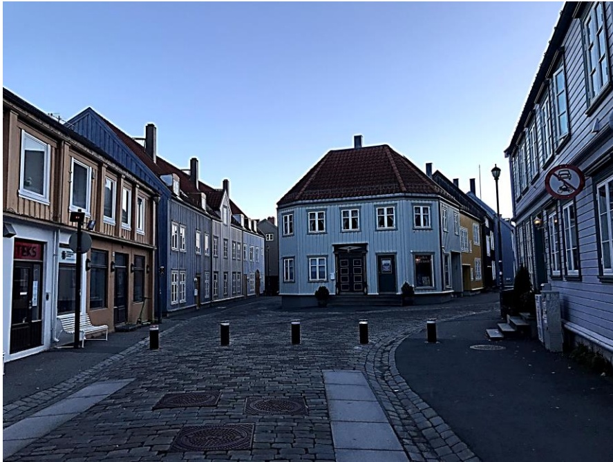
Figur 12.10, Eksempel på spærring for biltrafik med hæve-sænke-pullerter, som kan åbnes for biler med tilladelse via nummerpladegenkendelse (sensoren anes til venstre i billedet) (Trondheim, Norge).
