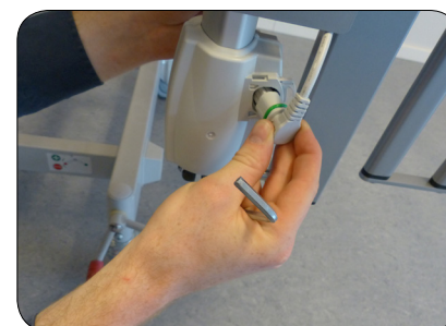
Tilslut aktuator kabel
