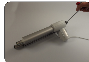
Fjern unbraco skruer og løs aktuatoren
