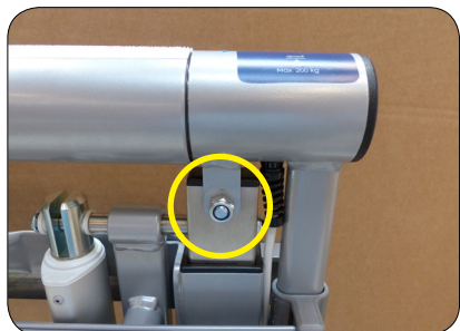
Afmonter motorrullen fra aktuatorbenet
